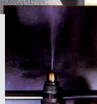
Aspecto de un inyector en contacto con un carburante convencional.
